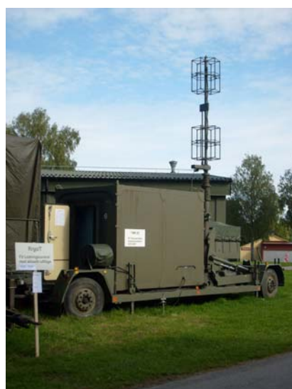
För att erhålla samband med flygplan i luften fanns en transportabel markradiostation TMR 20
